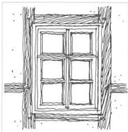
Die Skizze zeigt ein zweiflügeliges Holzfenster mit Kämpfer
